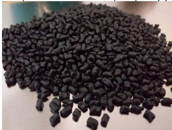
Figura 1. Pellets de composto usado como matéria prima para injeção de para-choques.
