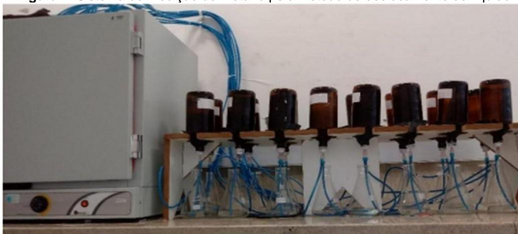
Visão geral do sistema de lavagem de biogás e medição do metano produzido.
