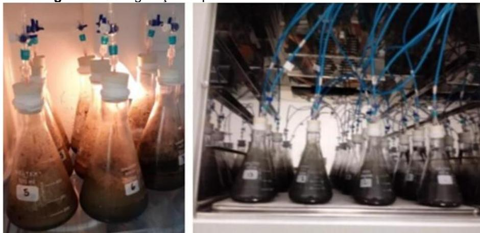
*Disposição dos reatores anaeróbios e o sistema de canalização dos gases produzidos no interior da estufa.*
