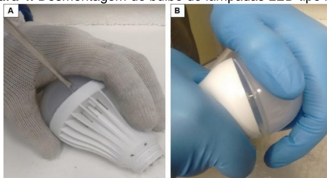
Figura 4. Desmontagem do bulbo de lâmpadas LED tipo bulbo
