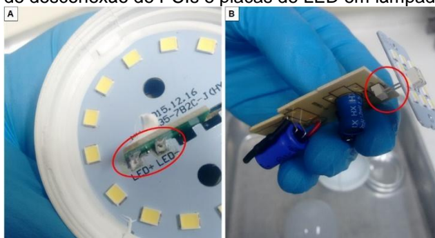
Figura 6. Forma de desconexão de PCIs e placas de LED em lâmpadas LED tipo bulbo
