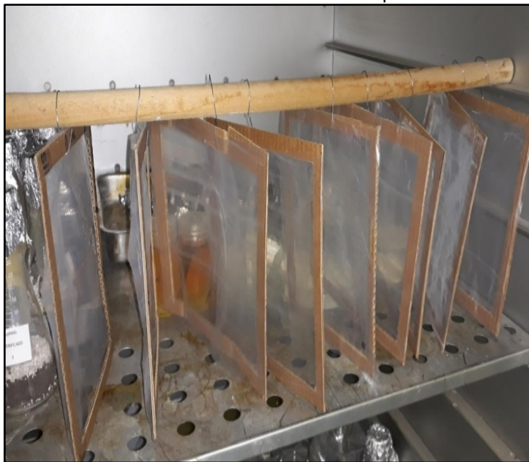
Figura 2 – Amostras dos filmes de PEAD/PEBD dispostos em estufa a 58°C
