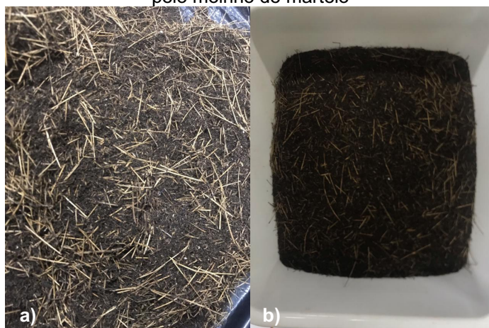
Figura 6. a) Composto antes de passar pelo moinho de martelo; b) Composto após passar pelas peneiras e pelo moinho de martelo
