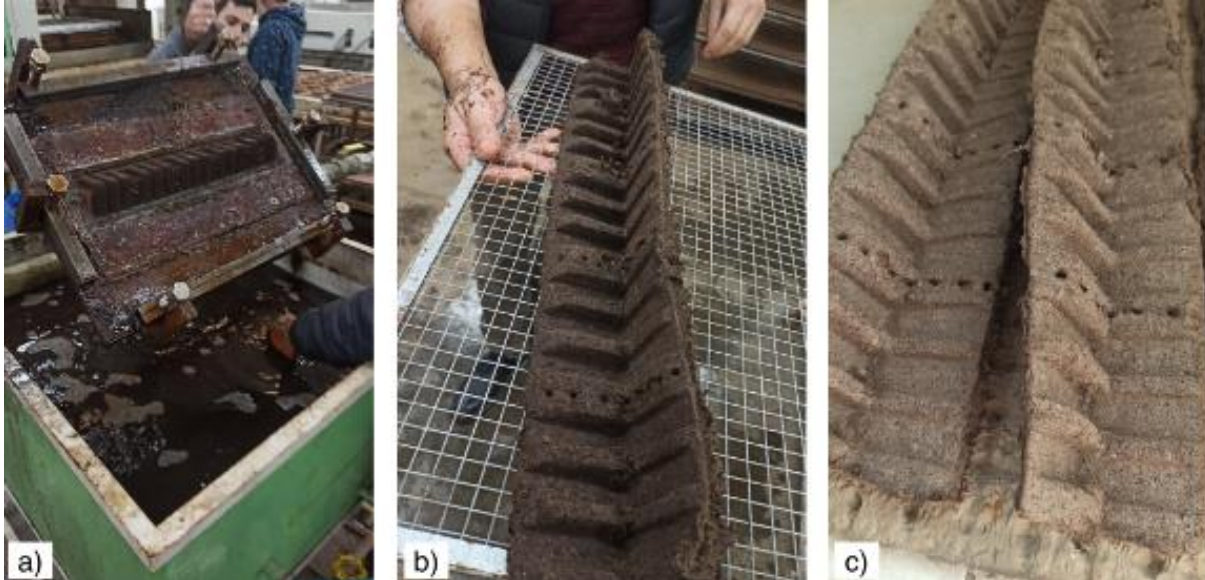
Figura 2. a) Máquina manual para moldagem por transferência; b) Peça moldada com celulose e pó de coco antes da secagem; c) Peça moldada seca
